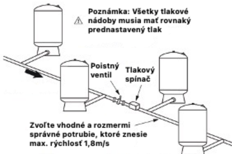
Obr. 1.5 Inštalácia viacerých tlakových nádob
